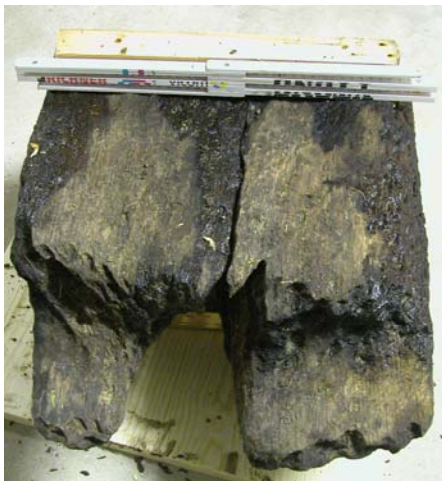
Foto 10: Eichenbalken, Nordende mit Zapfen
